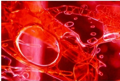
FOTO 10 - Rubino sintetico DOUROS Le inclusioni mostrate sono tipiche esclusive nella sintesi Douros e non sono state mai osservate né in rubini naturali né in quelli artificiali. Residua da fondente. Luce a campo scuro, 100x.
